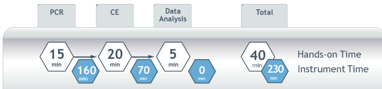
Figura 2. O fluxo de trabalho é simplificado de amostra-para-resposta, e pode ser realizado em menos de 5 horas com ~60 minutos de intervenção manual para 12 amostras. O tempo de execução do instrumento EC foi documentado para uma única injeção de 24 reações com a utilização de um Analisador Genético 3500xL da Applied Biosystems (24 capilares).
